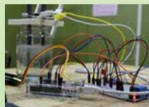
Der Natrium-Akku samt Laderegler.
